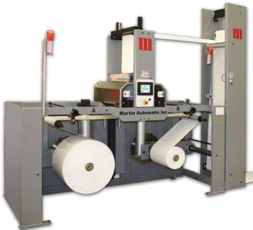
MBS 型对接式自动放卷机，带多功能减废系统。
