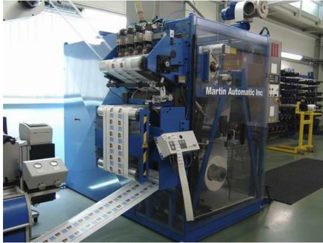
图 3: Cologne 印刷厂中的马汀 LRD 不停机收卷机与一台裁切设备连接使用
