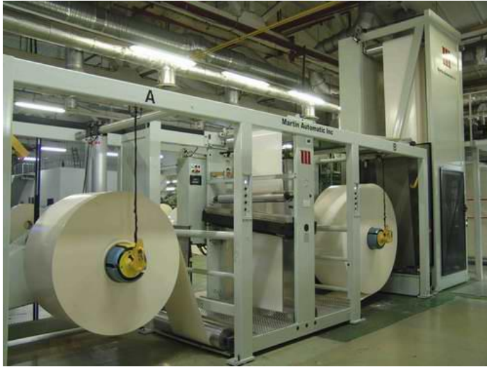
图 4: 在乌克兰 Elopak 公司安装的马汀不停机放卷设备提升该公司产能 15%
