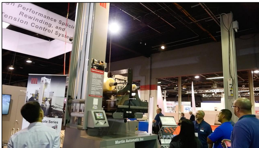
图：MLSW 可不停机放有黏性且无底纸的材料于主生产线中
