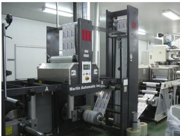
图 1：马汀公司 MBS 自动放卷机安装于 Nilpeter 印刷机
