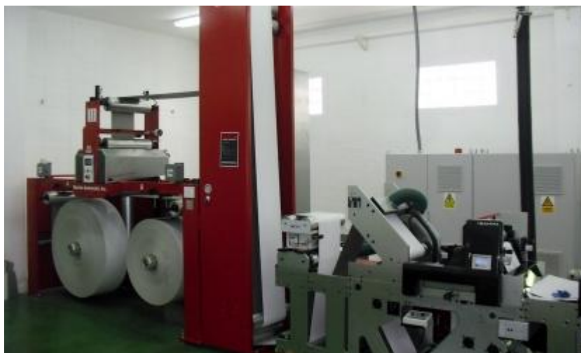
图：Aksorn 纸杯印制工司在新的 Edale FL-5 纸板柔印机上加装了马汀自动科技公司的不停机放卷设备
