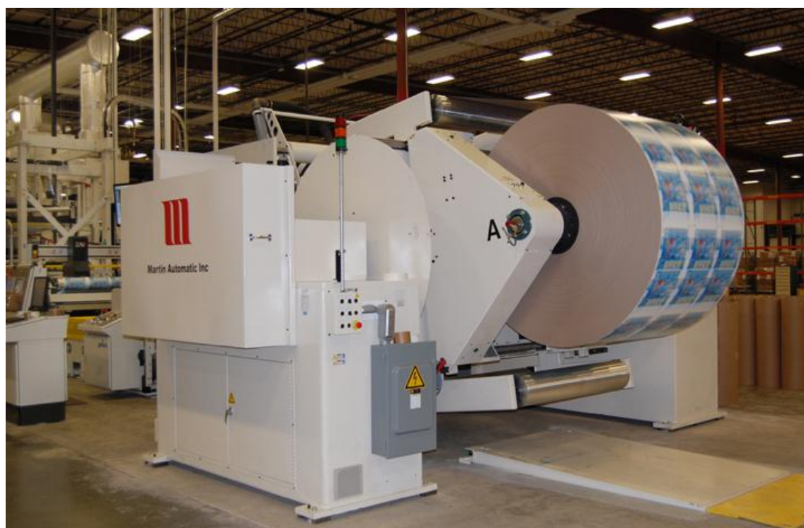
图说：马汀公司的 TR 自动不停机旋转式收卷系统安装于新的 Gallus 十色柔印机。
