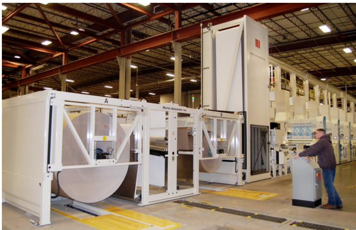
图说：马汀公司的 MCBWW 自动对接放纸系统安装于纸品集团新的十色 Gallus 柔印机，印速超过 330 米/分。
