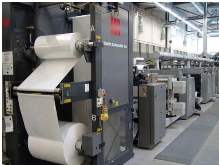
图 1:马汀 ECPF 不停机放卷机在德兰特—格贝尔印刷机上供应薄膜类材料。
