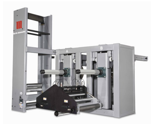
图 1：马汀 MLS 放卷机可轻松安装于窄幅轮转印刷机机体上方
