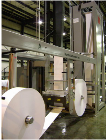
近期安装在信封生产线上的马汀 MBE 型对接式不停机放卷设备
