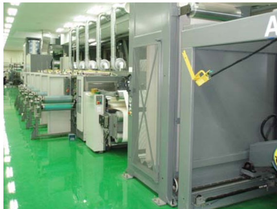
马汀不停机放卷装置搭配小森-尚邦印刷机
